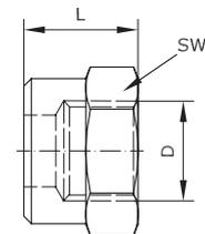
**Kontermutter aus Edelstahl für Schnellverschraubung**
