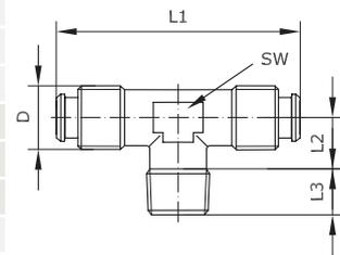
**T-Schnellverschraubung aus Edelstahl mit konischem Außengewinde, schwenkbar**
