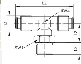
**T-Schnellverschraubung aus Edelstahl mit konischem Außengewinde**
